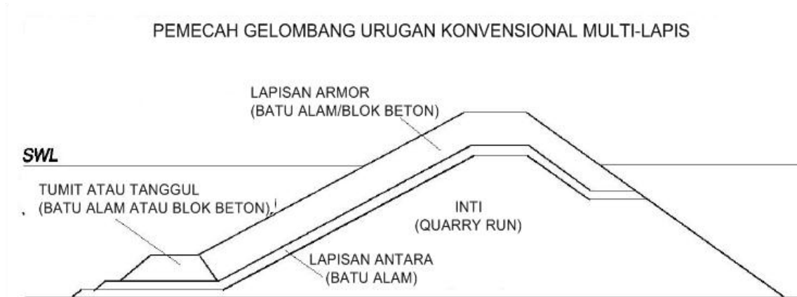
Gambar II.F.25 Pemecah gelombang urugan multi-lapis konvensional
